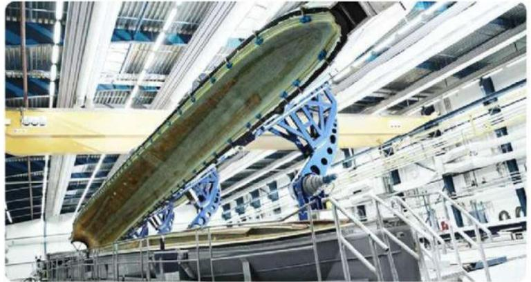
Beim Verarbeiten diverser Kunstharze, insbesondere beim „Anrühren“ und Aushärten ist Feuchtigkeit vollkommen unerwünscht. Beispielsweise bei der Herstellung von Rotorblättern der Windenergie-Türme, Feuchtigkeit im Verarbeitungsprozess kann einen gravierenden Stabilitätsverlust zur Folge haben.
